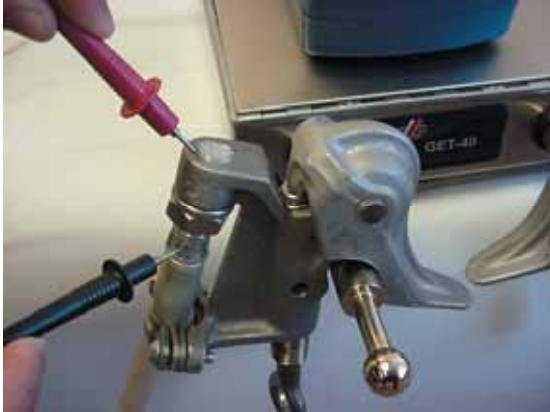
2x2点测试探头也可以用来检测特定的个人接地装置 (夹具、套环或电缆等)
